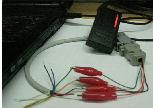
Imagen del conexionado de la placa adaptadora y la **fuentes de alimentación de 5VCC**.
